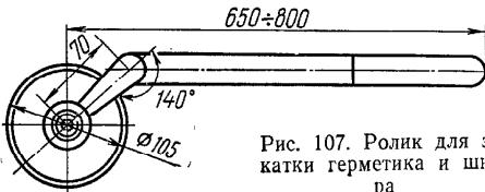
Рис. 107. Ролик для залатки герметика и шнура
