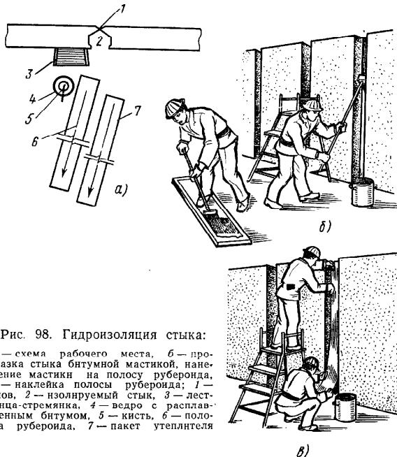
Рис. 98. Гидроизоляция стыка:
