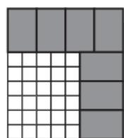
Перевязка с наружной стеной толщиной 380 мм
