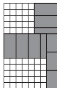
Широкий внешний угол ( $135^\circ$ ) и внутренний угол ( $225^\circ$ ) наружных стен — эркер
