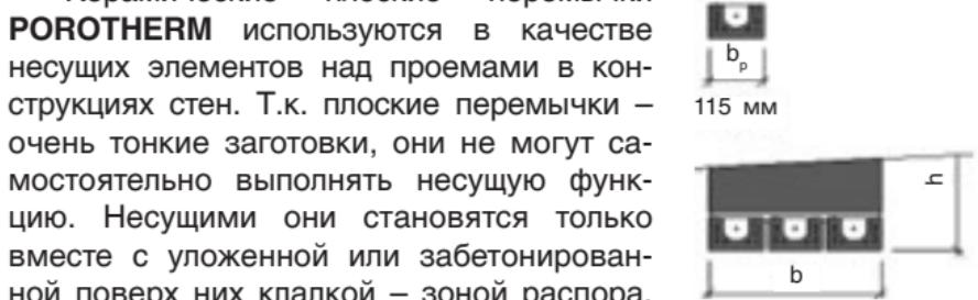
Обращаться с перемычками нужно особенно осторожно, чтобы не повредить их (надломить). Во время работы с отдельными перемычками они зачастую прогибаются, что не является дефектом. Для снижения риска повреждения перемычки рекомендуем при работе с перемычками повернуть их на  $90^\circ$  вокруг горизонтальной оси относительно положение, в котором они укладываются при строительстве.
