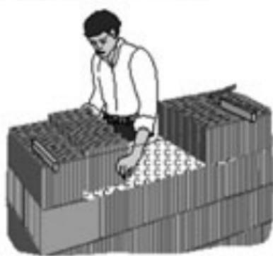
Укладывайте в свежий раствор кирпич за кирпичом вприятк вдоль шнуря (перевязка в паз и гребень обеспечивает правильную укладку кирпичей). Положение кирпичей проверяйте по уровню и рейке и поправляйте с помощью резинового молотка. Керамические блоки не должны выступать за фундамент или перекрытие более чем на 25 мм!
