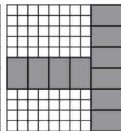
Перевязка с внутренней стеной толщиной 250 мм
