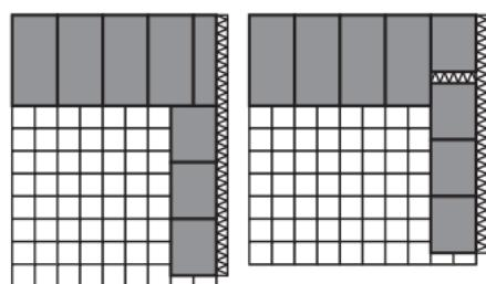
Внутренний угол наружной стены в месте соединения с внутренней стеной толщиной 250 мм
