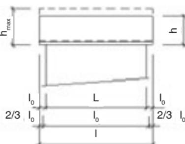
перемычками – зоны распора – можно использовать обожженные, силикатные, бетонные кирпичи и блоки, поперечная прочность которых (т.е. после укладки над перемычками вдоль горизонтальных осей перемычек) составляет в среднем хотя бы 2,5 МПа, а по отдельности – хотя бы 2,0 МПа.
